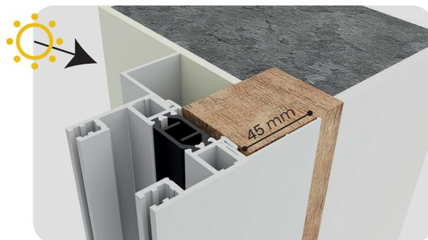
Dormant rénovation avec couvre joint de 45 mm
